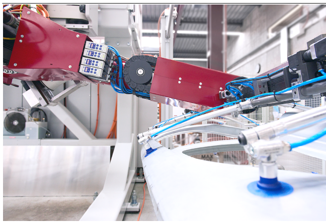
Ejecteurs compacts SXMPi classe B pour la manipulation d'une pièce de pliage de tôle
